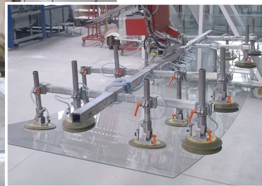
De passerelle valt uiteen in drie zones waar de buiging telkens een specifieke radius kent: 1.700 mm, 5.250 mm en 13.000 mm. Het ontwerp en de productie van alle concave en convexe elementen moest met de grootst mogelijke precisie gebeuren. Links: het glas in de buigmal; rechts: vakkundige manipulatie
