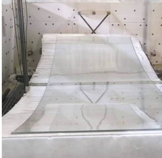
De passerelle valt uiteen in drie zones waar de buiging telkens een specifieke radius kent: 1.700 mm, 5.250 mm en 13.000 mm. Het ontwerp en de productie van alle concave en convexe elementen moest met de grootst mogelijke precisie gebeuren. Links: het glas in de buigmal; rechts: vakkundige manipulatie
